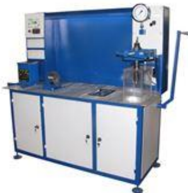
Рисунок 2 – Стенд для очистки
