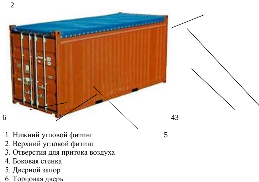
Рисунок 1 – Общее устройство универсального грузового контейнера
