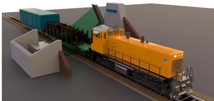
Рисунок 1 – Рентгеновский сканирующий комплекс АДАНИ TRAINSCAN
